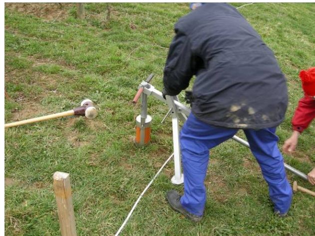
Abb. 3-5: Entnahme von Bodenproben zur Bestimmung von Elementkonzentrationen und Lagerungsdichten
