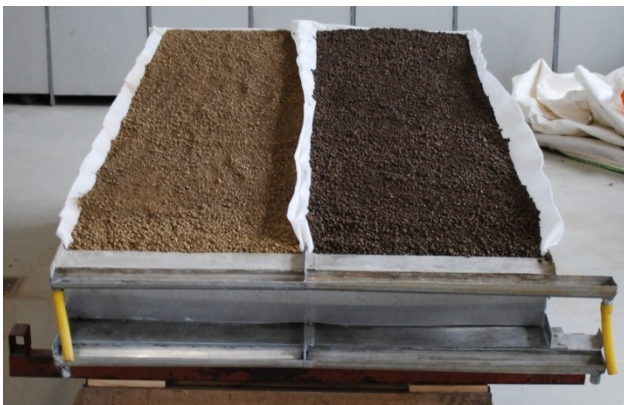
Abb. 4-108: Der markierte Boden nach erfolgtem Einbau in die Messparzelle vor der Beregnung. Links: lufttrockener Boden; rechts: Wassergehalt ca. 20 ww%.
