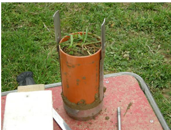
Abb. 3-7: Entnahme von Bodenproben zur Bestimmung von Elementkonzentrationen und Lagerungsdichten
