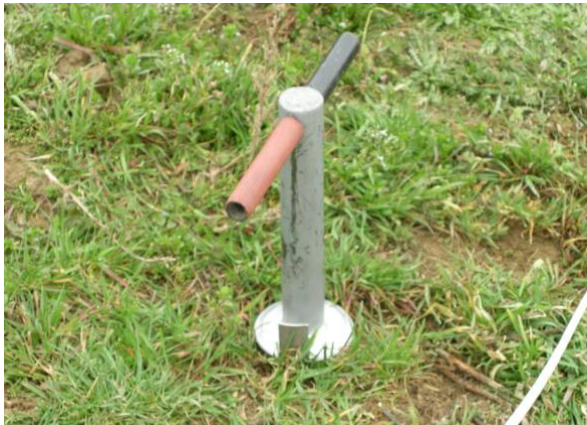
Abb. 3-6: Entnahme von Bodenproben zur Bestimmung von Elementkonzentrationen und Lagerungsdichten
