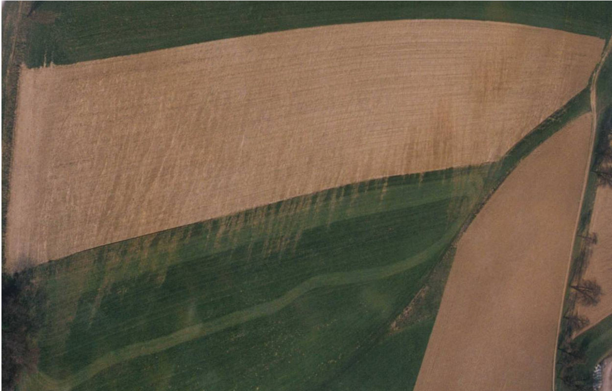
Abb. 4-10: Luftbild von Bodenerosion und Sedimentablagerung für das Niederschlagsereignis März 2002 am Modellhang Grub
