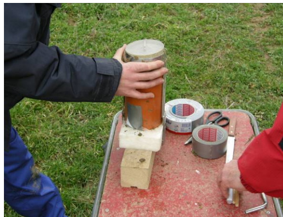
Abb. 3-9: Entnahme von Bodenproben zur Bestimmung von Elementkonzentrationen und Lagerungsdichten
