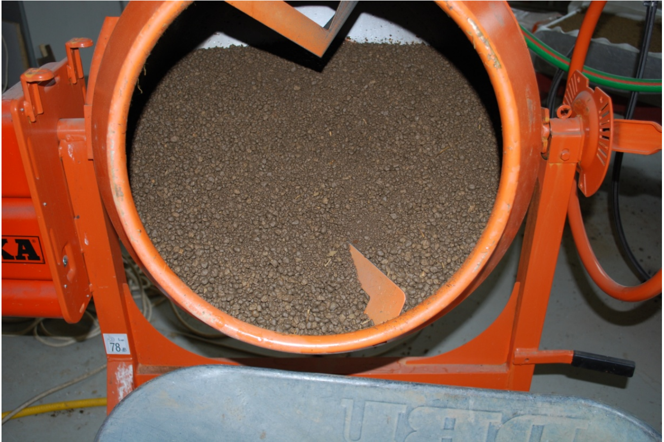
Abb. 4-107: Mischung von Wirkstoff und Bodenmaterial in einem Betonmischer
