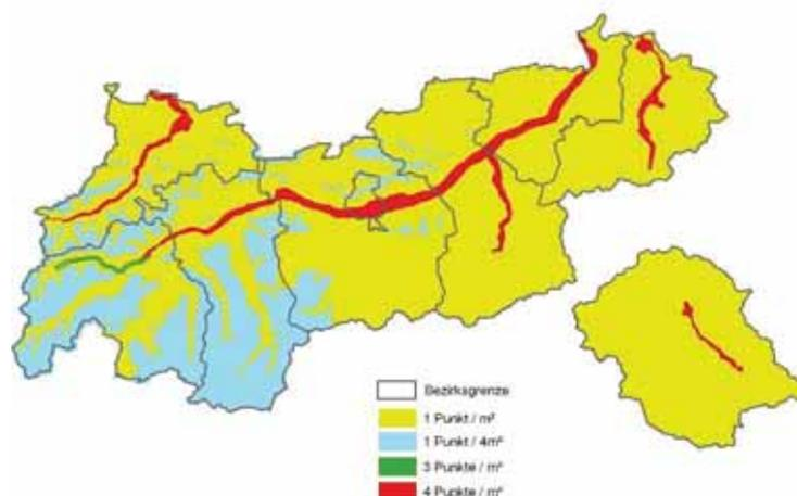
Abbildung 3: Mittlere Punktdichte der Laserbefliegungen des Landes Tirol (Land Tirol (2010))
