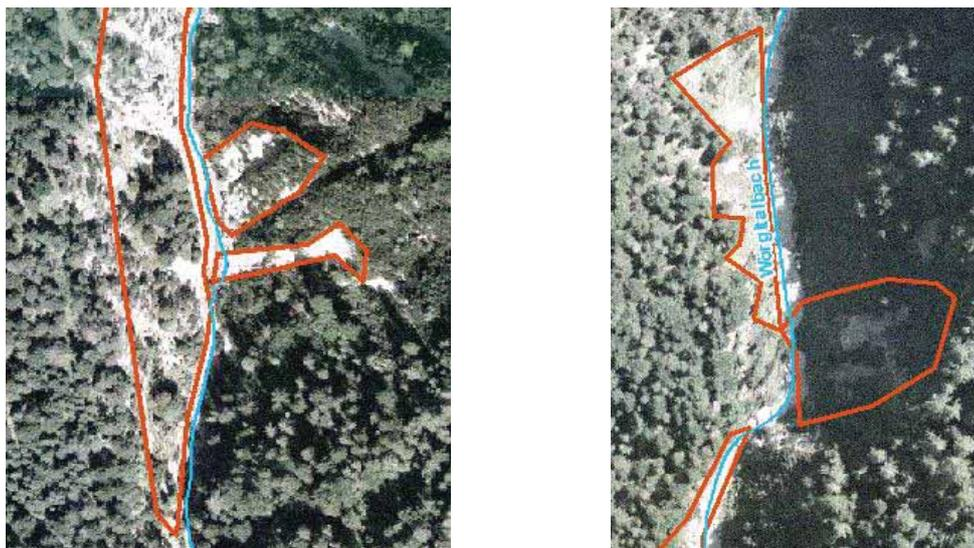
Abbildung 19: Ableitung von Flächen mit Rutschungspotential aus dem Orthofoto (orange). Links der Bachabschnitt des Ehnbaches kurz oberhalb des Wildholznetzes (Abschnitt 8 I in der Maßnahmenplanung Ehnbach im Anhang), rechts ein Abschnitt aus dem Mittellauf des Wörglbaches.
